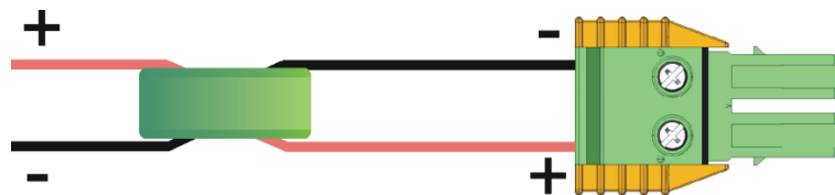
Abb. 6. Einbau vom Ferritkern in das DC – Stromversorgungskabel zum Verstärkeranschluss.
